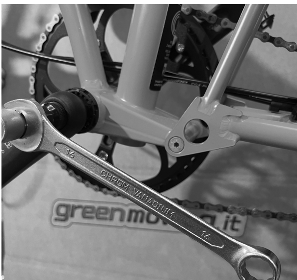
Fig. Solo ora spostare la chiave del 16 sulla porzione argento dell'estrattore ed avvitare. In senso orario, una volta raggiunto il fine corsa, applicare molta forza avvitando per far sì che la pedivella venga sbloccata ed estratta.
