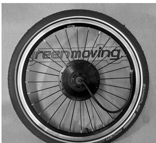
Fig. 1 Riceverete il motore già raggiato su cerchio Brompton, monterete il vostro copertone, camera d'aria e flap (giallo) presente sul cerchione originale a copertura delle niples.
