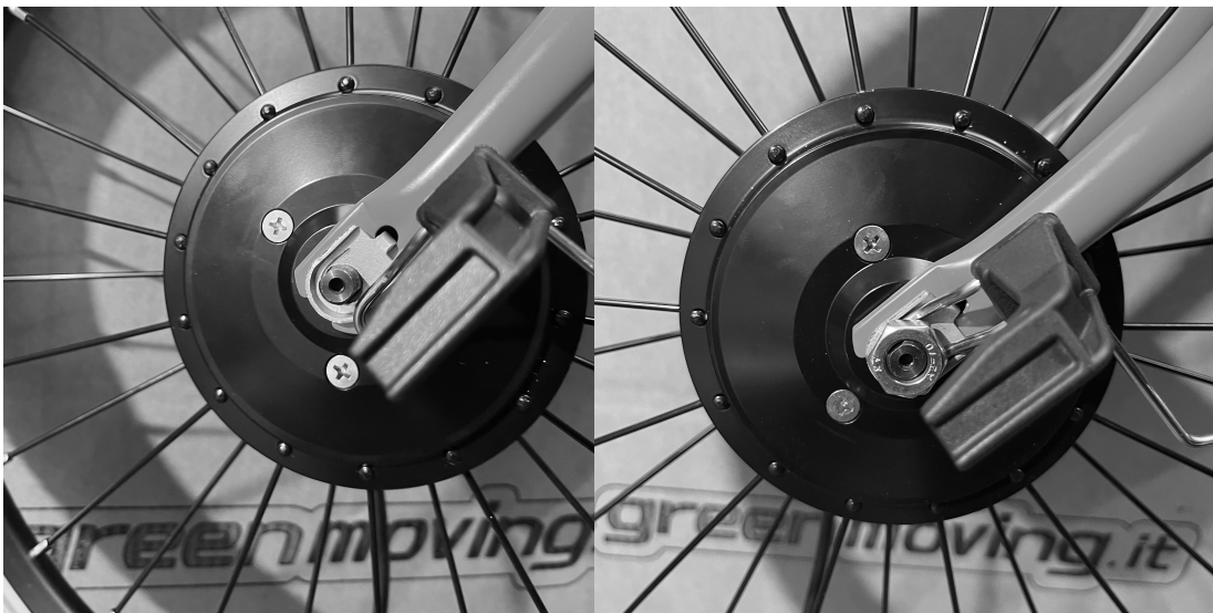
Fig. Avvitare il dado senza apporvi rondelle. Ora serrare bene da entrambi i lati. Tenere con una mano il gancio per non farlo ruotare.
