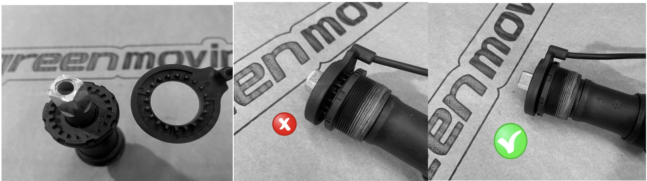
Fig. N.B. Una volta posizionato correttamente la direzione del PAS (vedi fig. sopra), fare in modo che i dentini entrino negli antagonisti presenti sul movimento centrale, applicare una leggera pressione sul PAS per farlo entrare bene in sede.
